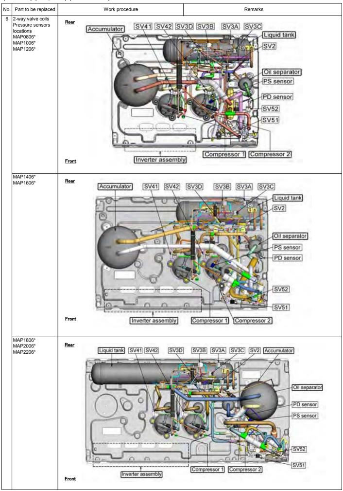
(For T8(J)P, T7(J)P, T8P-SG, T8(J)P-ID, T8(J)P-T model)
