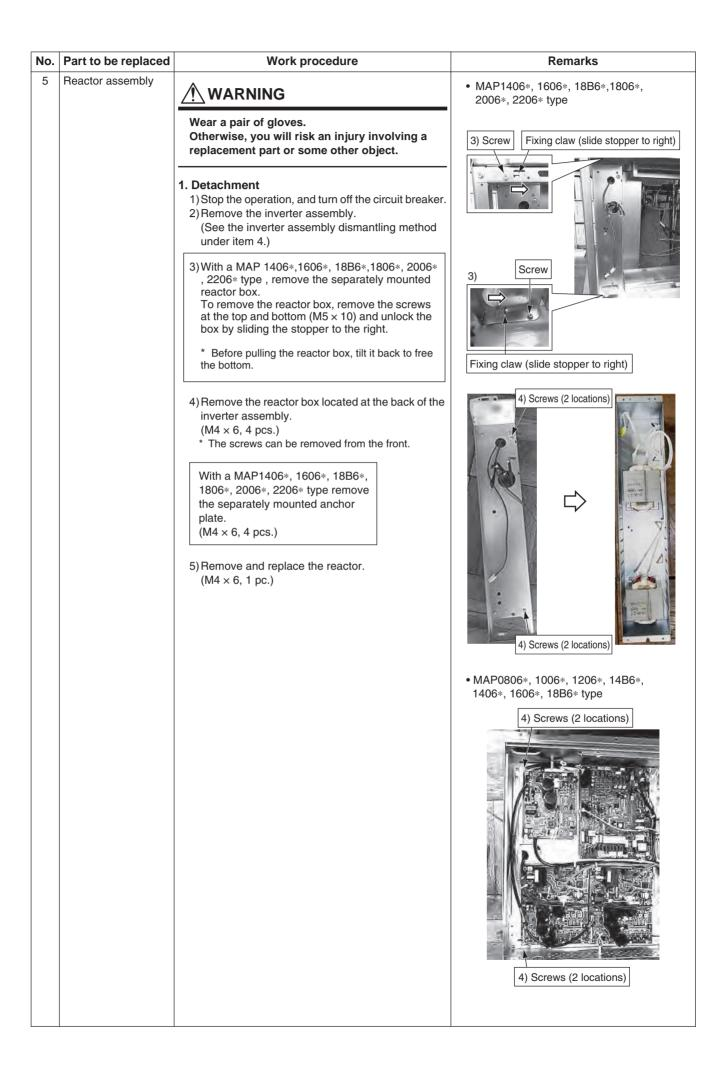
For HT8(J)P, HT7(J)P, HT8(J)P-ME, HT7P-ME, T8(J)P-E, HT8P-A, HT8P-C model
