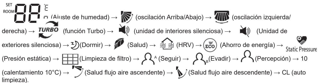
Cuando seleccione una función, el ícono correspondiente destella, y usted puede ver la tecla de MENÚ para la función fijar/cancelar o introducir la correspondiente interfaz de ajuste de función.
