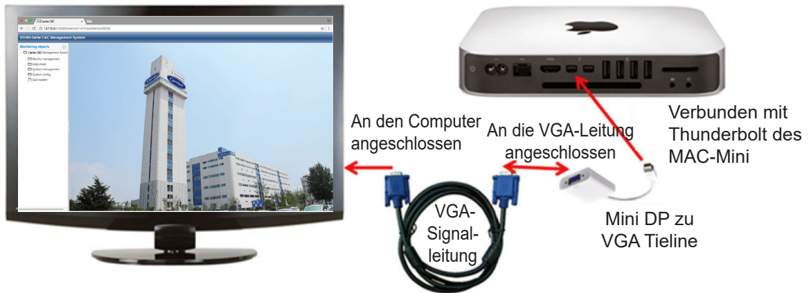
Anschlussdiagramm des MAC-Mini und des Displays
