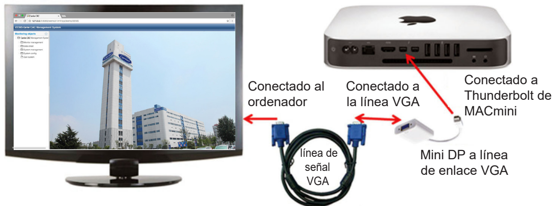
Diagrama de MAC mini y conexión de visualización
