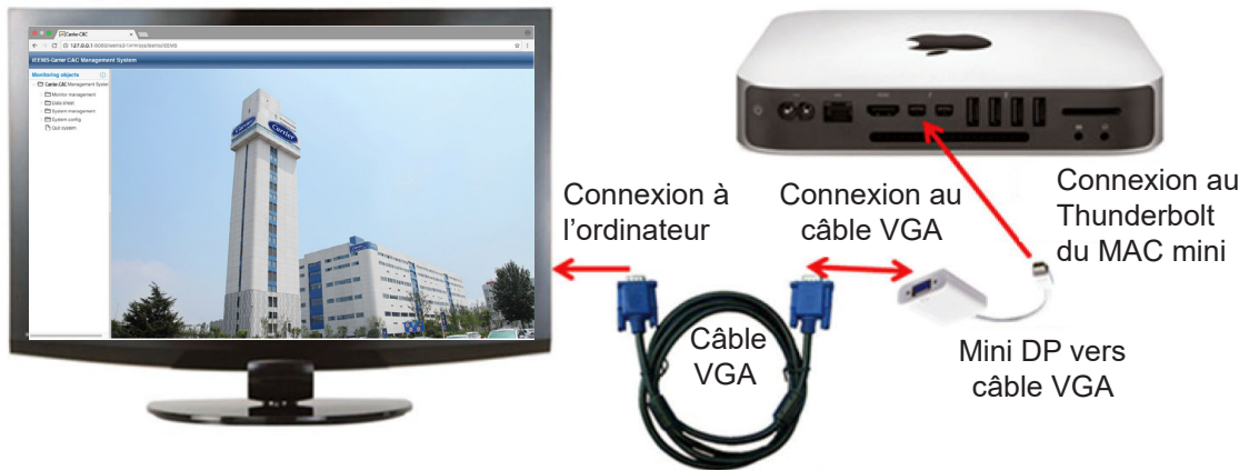
Schéma de connexion du Mac mini au moniteur
