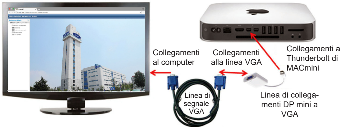
MAC mini e schema di collegamenti del display
